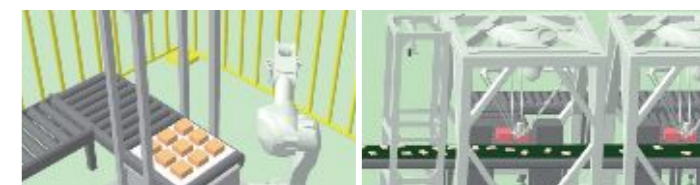
通过固定相机或手眼相机校准对象物的抓取位置
