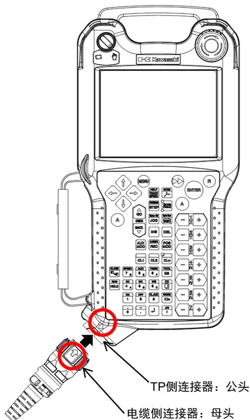
拆下连接器时，请握住连接器的螺母部分，逆时针旋转约45度，解除锁定，然后将其笔直拉出。
