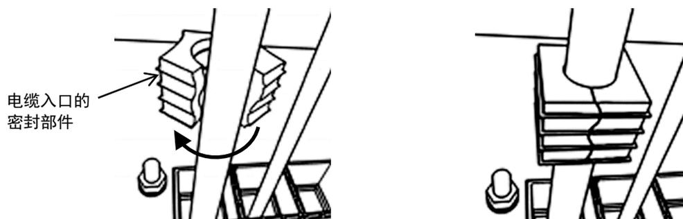
10. 将电缆入口的密封部件推入网格状部件，直到无法推动。
