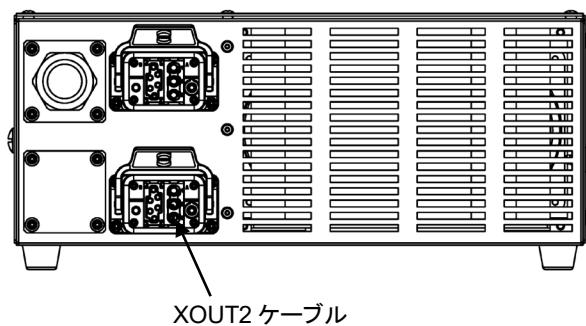
6. XOUT2ケーブルの先端をトランスユニット内の端子台に、マイナスドライバなどを使って接続します。
