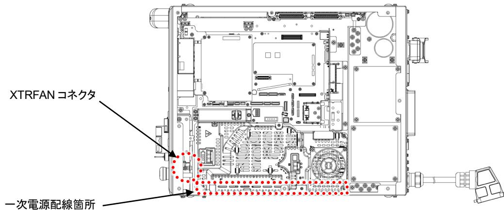
5. コントローラ内の“XTRFAN”コネクタの既存のジャンパコネクタを外して、電源ケーブルについているコネクタを接続します。(外したジャンパコネクタは使用しません。)
