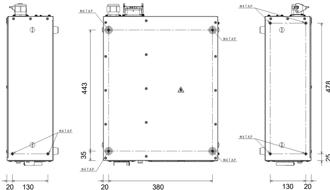
例) 2mmの板にコントローラを固定する場合のボルト長さは15mm以下
