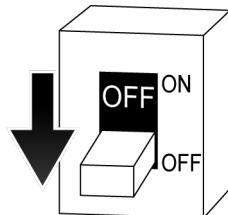
2. トランスユニットの制御電源スイッチをOFFにします。
