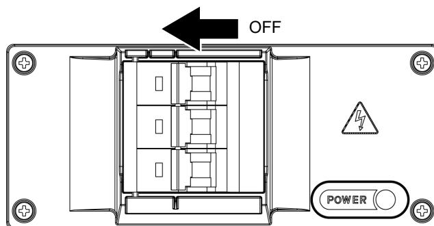
3. 制御電源スイッチの前面カバーを開けます。
