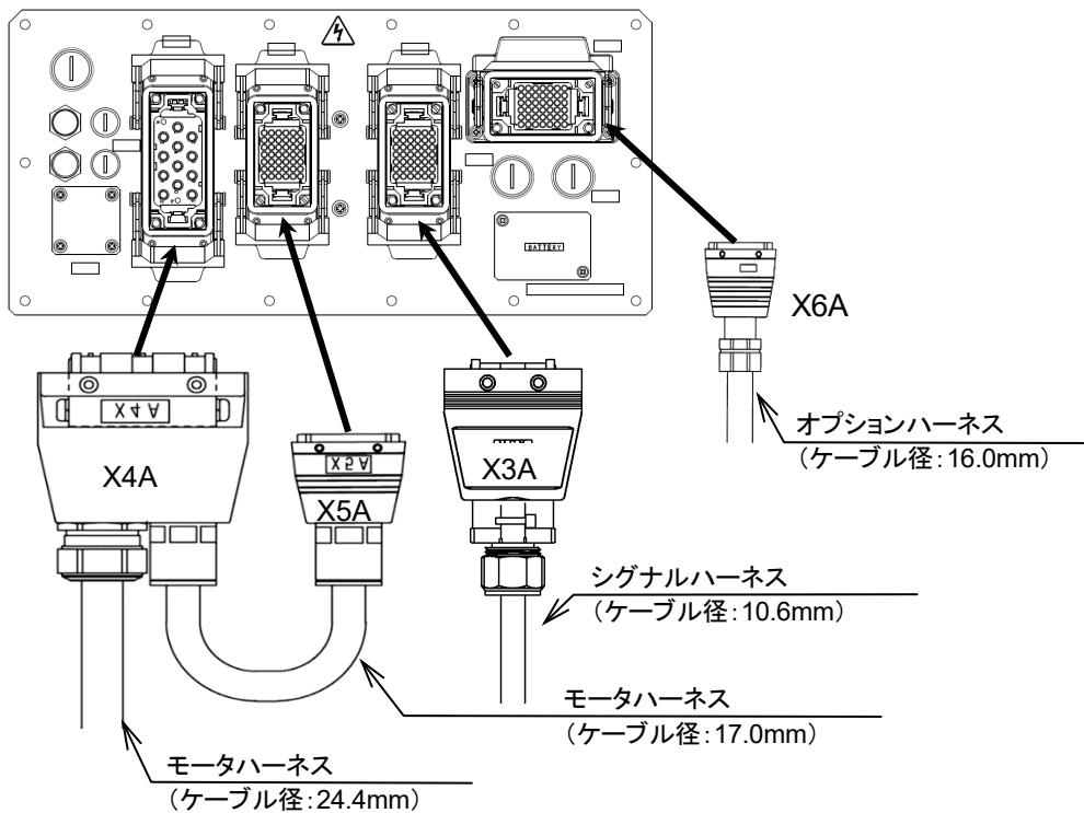
各ケーブルの外形サイズ、および最小曲げ半径は下表を参照してください。
