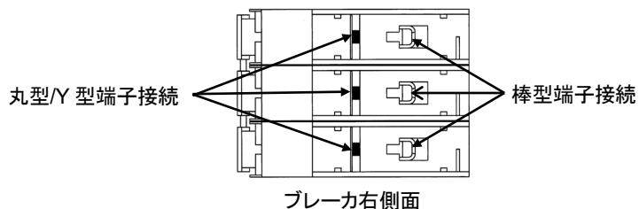
6. ブレーカ右側面の図に示す位置に電源ケーブルを接続します。
