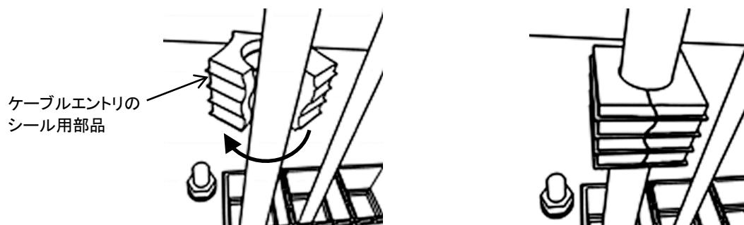
10. ケーブルエントリのシール用部品を格子状部品に最後まで押し込みます。
