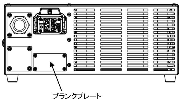
5. オプションのXOUT2ケーブル(品番:50977-6317)を手順4.で取り外した場所に取り付け、コントローラの電源ケーブルをXOUT1コネクタ、XOUT2コネクタに接続します。
