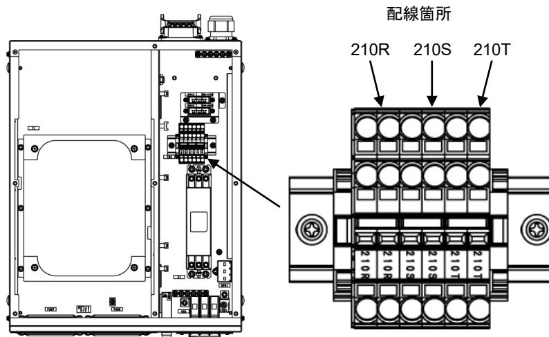
7. XOUT2ケーブルを下図に示した場所で結束します。
