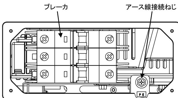
7. ブレーカ右側面の図に示す位置に電源ケーブルを接続します。
