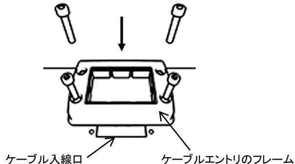
7. ケーブル入線口から外部I/Oケーブルをコントローラ内に引き出します。
