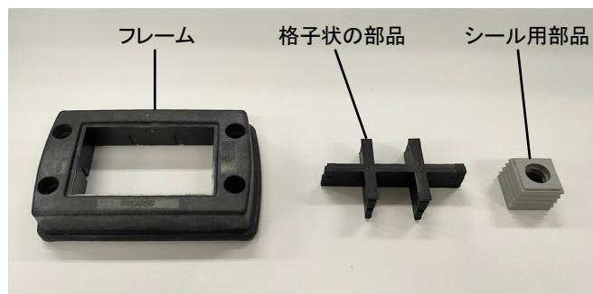
6. ケーブルエントリのフレームをコントローラに取り付けます。
