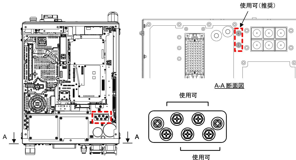
12. 外部I/Oケーブルをコントローラのケーブルクランプ位置に結束します。
