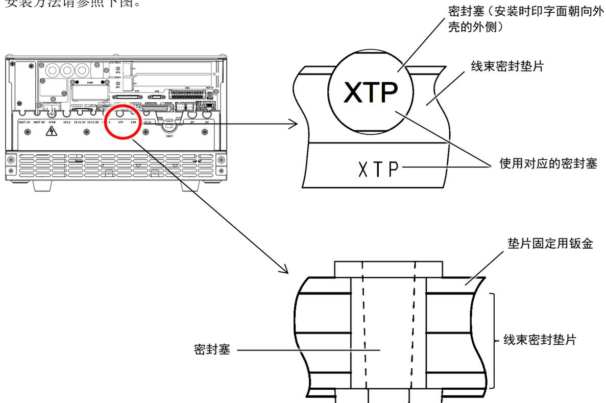
3. 在密封规格背面单元主体的线束密封垫片上固定各线束时，请按下图所示，避免垫片夹住线束。
