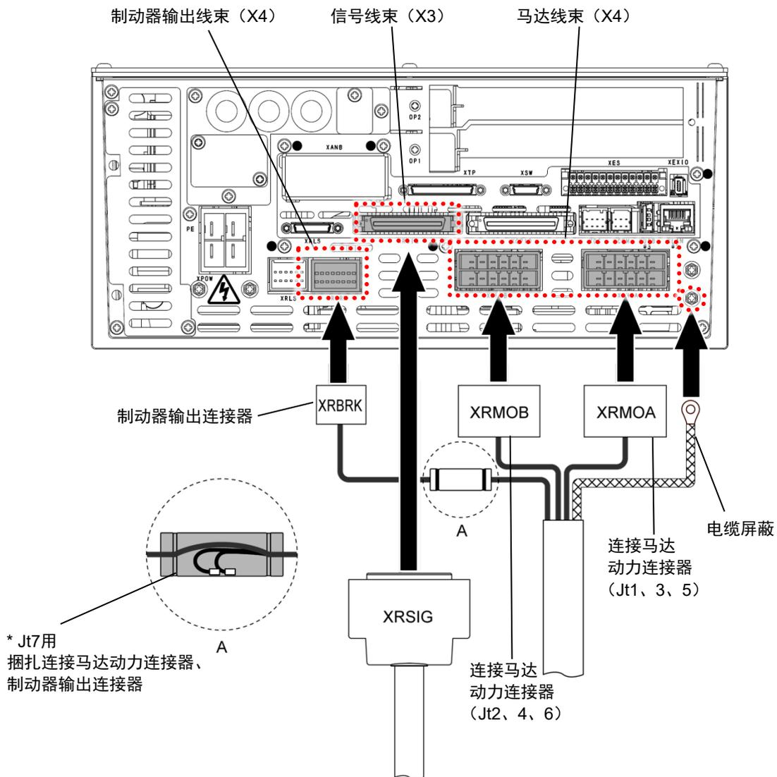
F60开放型标准规格如需遵守UL标准，请按照以下注意事项，在控制器背面安装连接器盖板。\*
