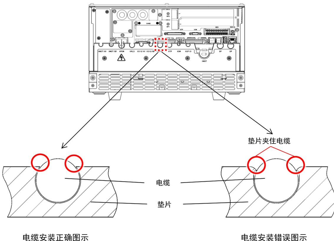
4. 在密封规格背面单元主体上安装线束后，因更换线束等理由从线束密封垫片上取下线束时，请更换新的线束密封垫片。更换步骤如下。
