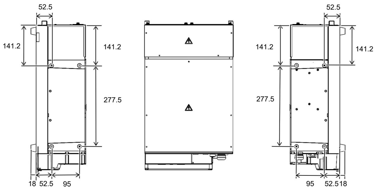
例如： 将控制器固定在2mm厚的面板上时，螺栓长度为15mm以下
