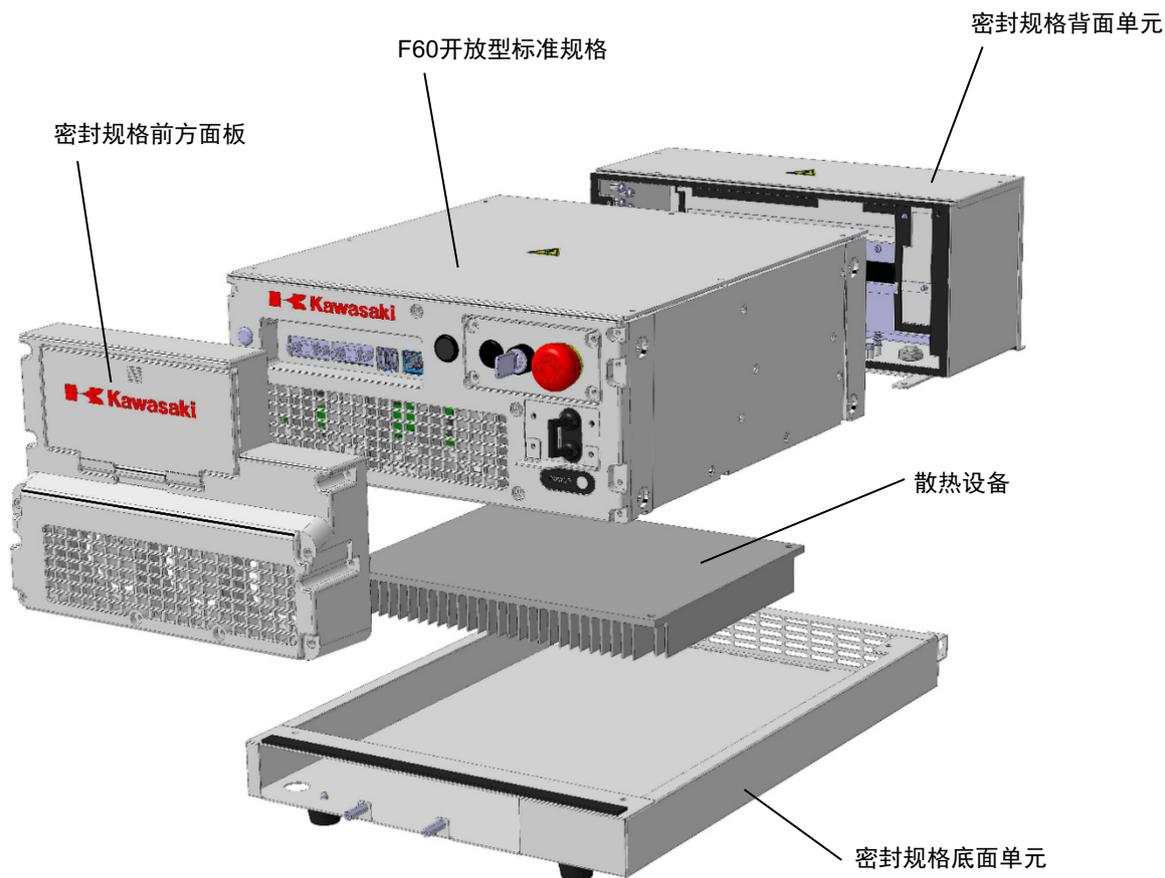
本页后，F60开放型标准规格加装密封外壳选购件的外壳统称为“F60密封规格”。关于密封外壳选购件的安装方法，请参阅《选购件安装手册》。
