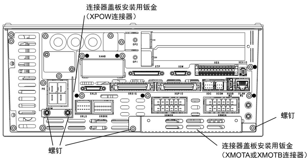
2. 将马达线束和电源电缆的连接器插入控制器。
