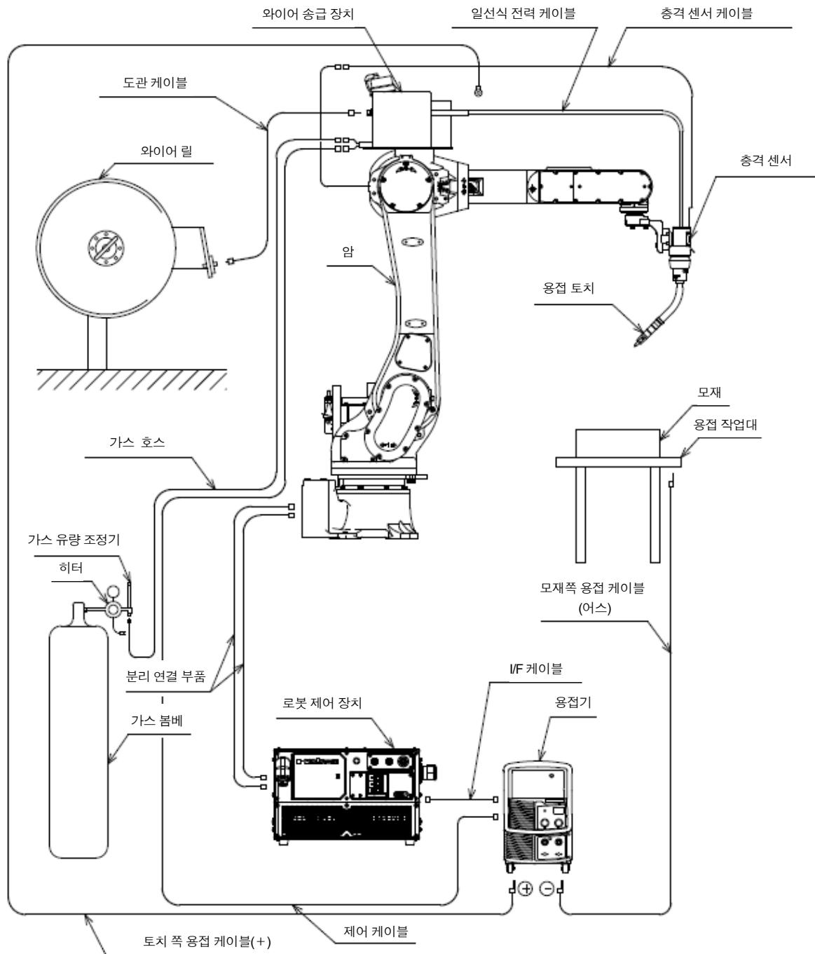
그림4.1 용접 기기와의 접속 예 (주)다이엔제의 용접 전원(WB-M350)을 접속한 경우)
