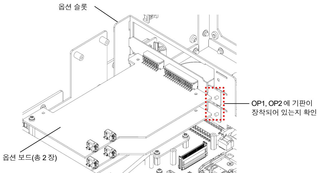
5. 「5.3 F01 컨트롤러 OP1에의 설치」의 순서2.와 같이 아크 용접 인터페이스 보드(1-1)와 옵션 슬롯 고정 판금(1-3)을 조립합니다.
