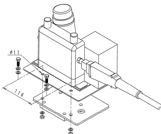
그림 1.2 와이어 송급 장치의 설치(순서 2)
