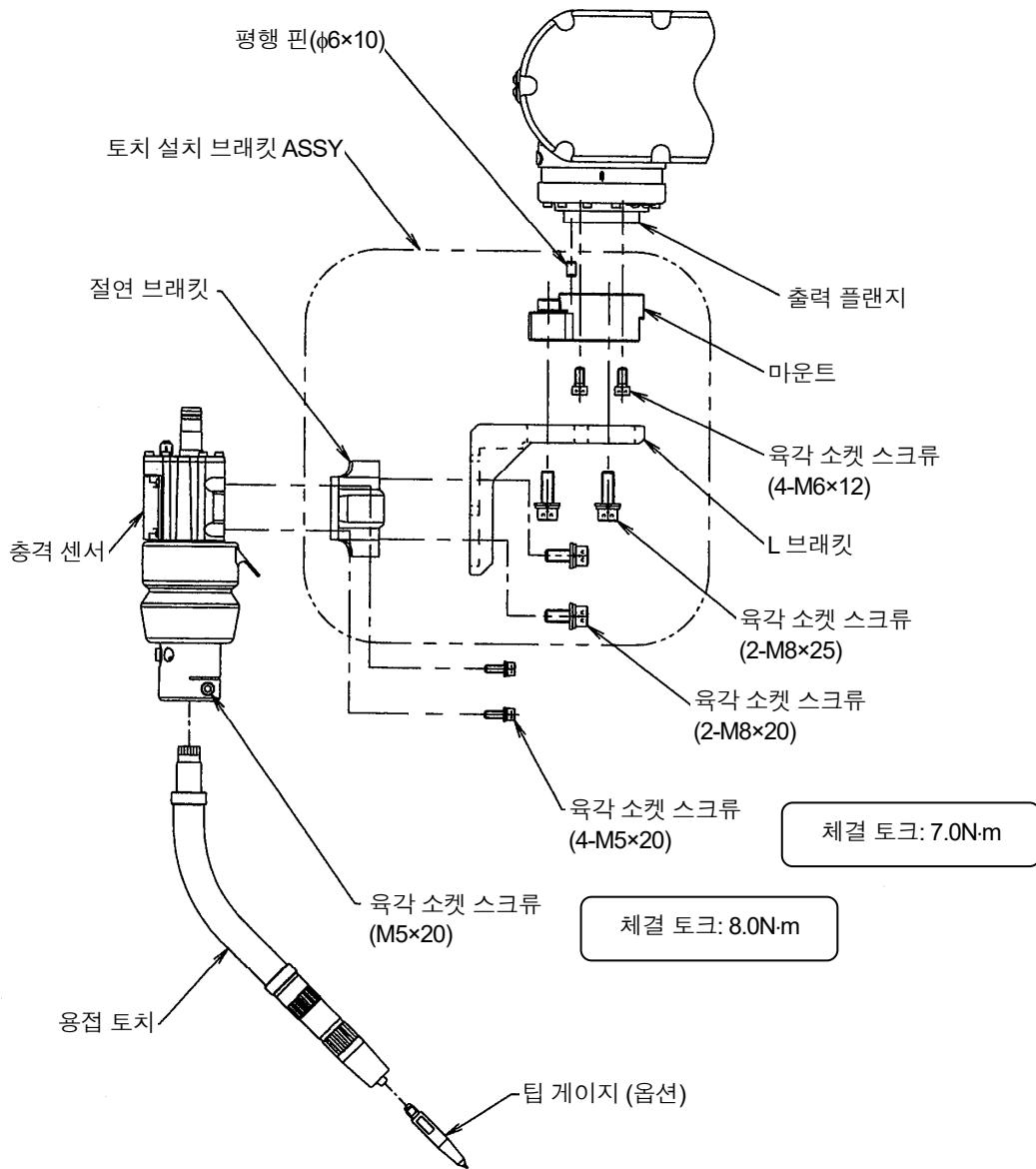
그림 2.1 토치 및 충격 센서의 설치
