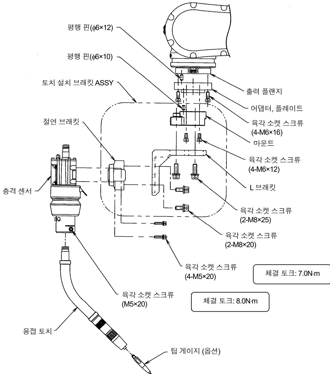
그림 2.2 토치 및 충격 센서의 설치
