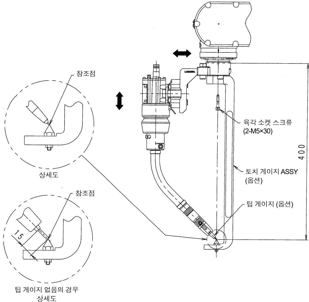
그림 2.4 토치 게이지의 설치
