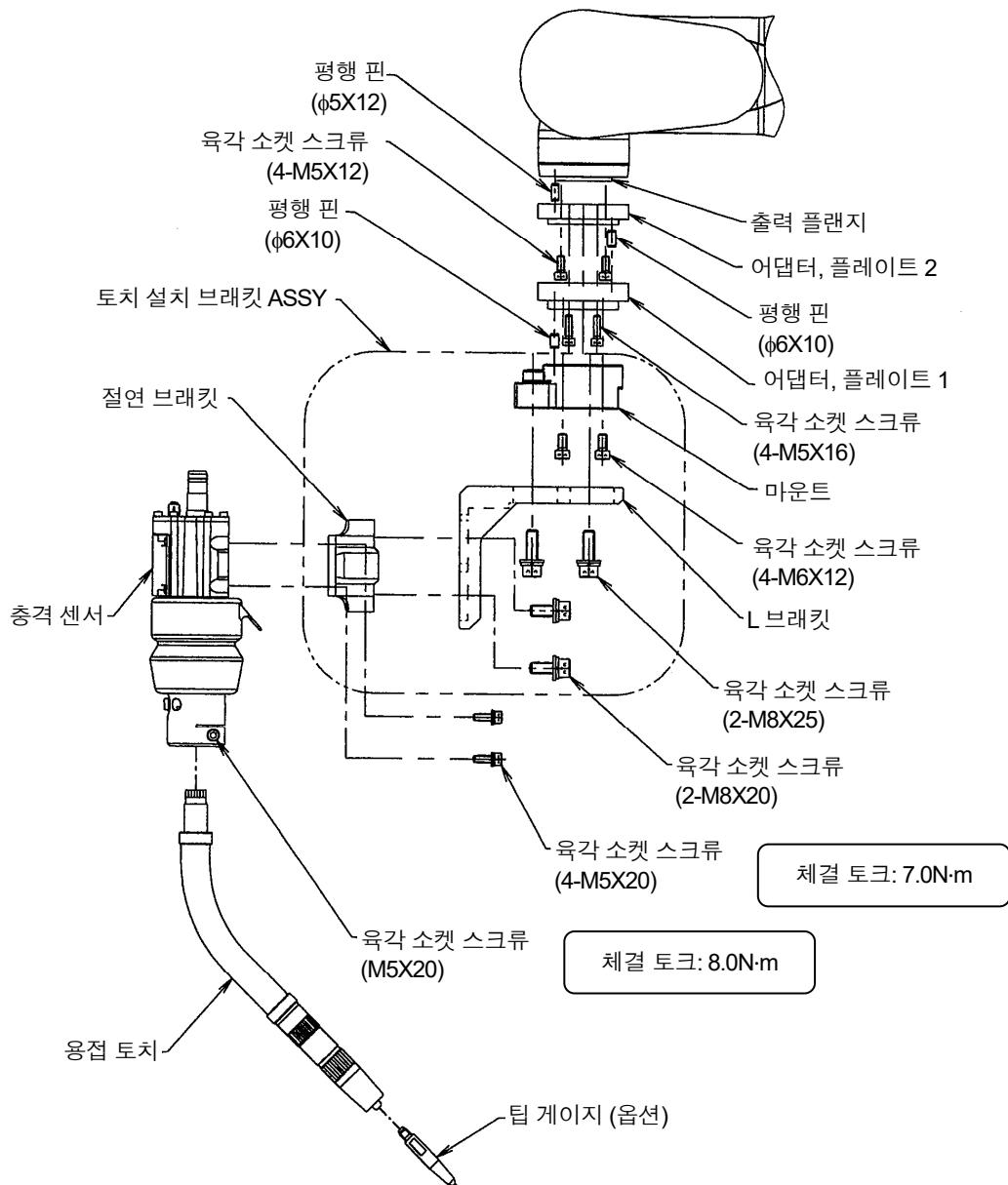
그림 2.3 토치 및 충격 센서의 설치
