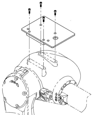
그림 1.1 고정 브래킷의 설치(순서 1)
