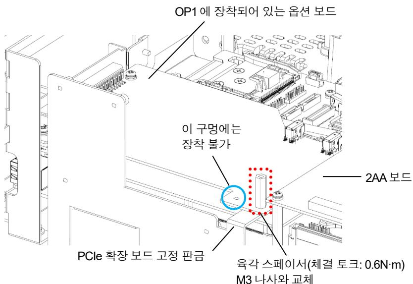
7. 옵션 슬롯에 순서5.에서 조립한 아크 용접 인터페이스 보드 어셈블리를 장착합니다. 장착 시, 판금의 돌출부를 옵션 슬롯의 삽입구에 끼워 주십시오. 끼운 후 첨부된 M3 나사(1-4)로 1곳을 고정합니다. (체결 토크: 0.3N·m)
