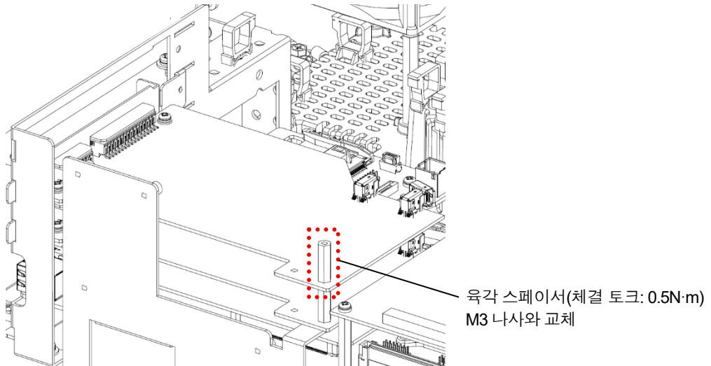
7. 옵션 슬롯에 순서2.에서 조립한 아크 용접 인터페이스 보드 어셈블리를 장착합니다. 장착 시, 판금의 돌출부를 옵션 슬롯의 삽입구에 끼워 주십시오. 끼운 후 첨부된 M3 나사(1-4)로 1곳을 고정합니다. (체결 토크: 0.3N·m)
