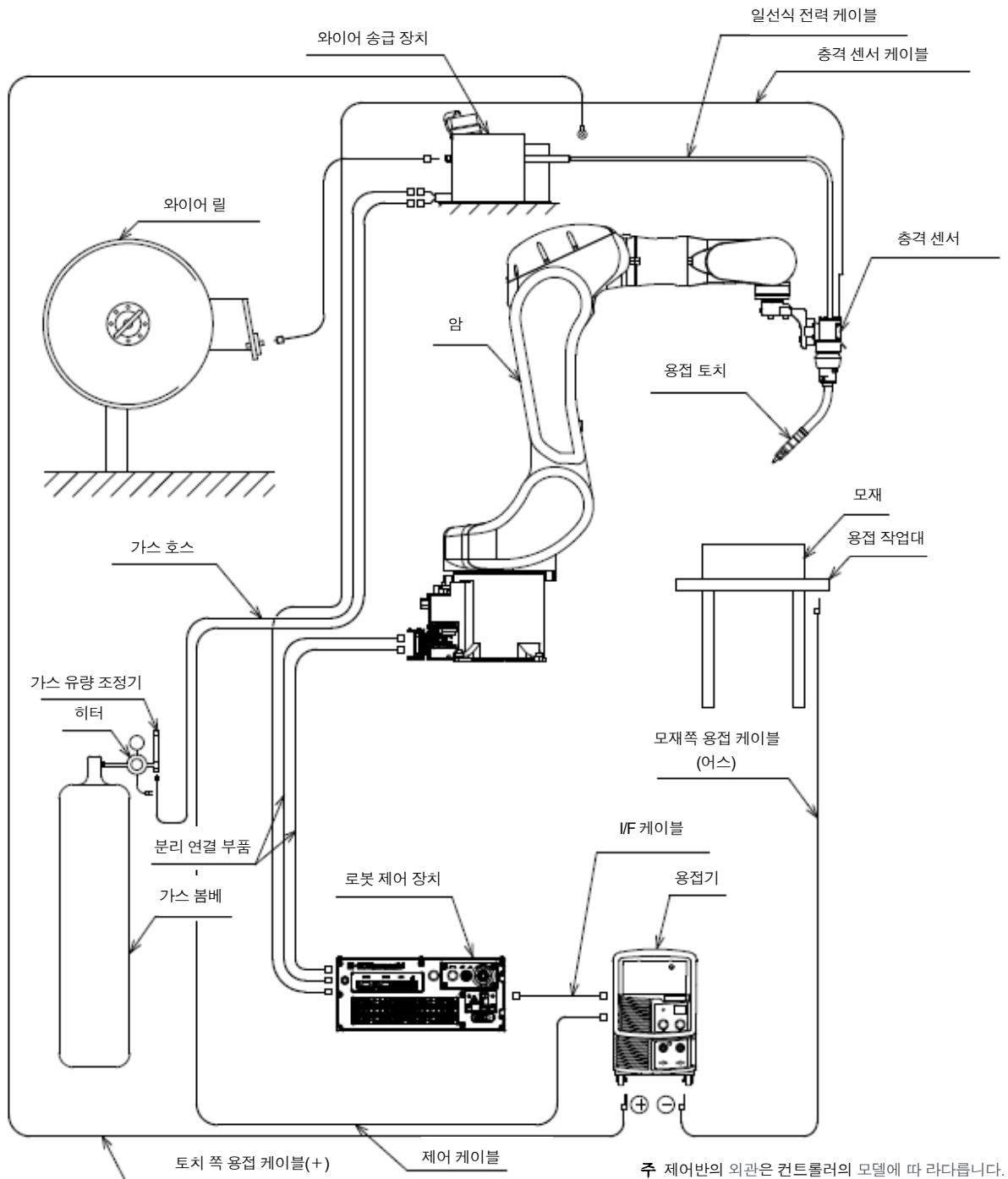
그림4.2 용접 기기와의 접속 예 (주다이헨제의 용접 전원(WB-M350)을 접속한 경우)
