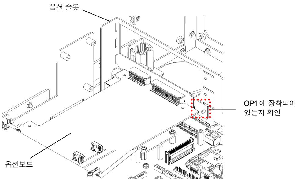
5. 「5.3 F01 컨트롤러 OP1에의 설치」의 순서 2.와 같이 아크 용접 인터페이스 보드(1-1)와 옵션 슬롯 고정 판금(1-3)을 조립합니다.
