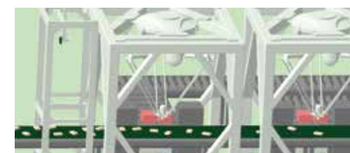
コンベアと同期し、移動する対象物の現在位置を検出
