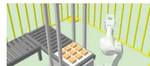
固定カメラやハンドカメラによる対象物の把持位置補正
