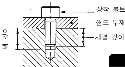
장착 볼트의 길이는 툴 설치 플랜지의 텁 깊이에 맞추어 규정된 체결 깊이가 되도록 선택해 주십시오. 또, 장착 볼트는 고장력 볼트를 사용해, 규정의 토크로 단단히 체결해 주십시오.
