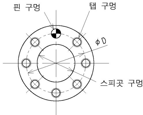
로봇 암의 선단부에는 핸드 및 건의 툴을 장착하기 위한 플랜지가 있습니다. 장착용 볼트는 왼쪽 그림과 같이 플랜지 위의 øD 원주상에 가공된 텁 구멍을 이용해 단단히 체결해 주십시오. 또, 핸드 및 건과의 위치 결정은 핀 구멍과 스피곳 구멍을 이용해 주십시오.
