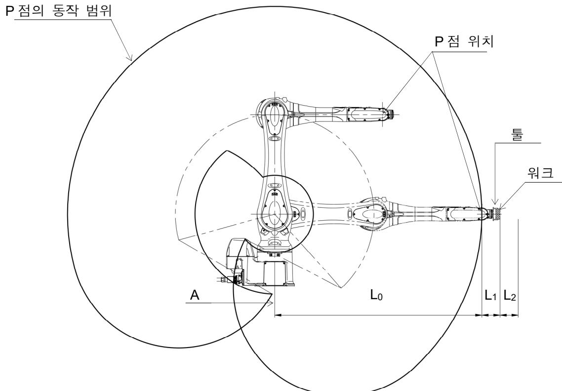
후술하는 로봇의 동작 범위는 그림 안의 P 점의 동작 범위를 나타내고 있습니다. 따라서, 안전 펜스는 암의 중심선(그림 안의 A)으로부터  $L_0$ 의 치수+손목의 플랜지까지의 치수와 툴의 최대 치수의 합 :  $L_1$  한층 더 여유 있는 치수 :  $L_2$ 를 더해 그림과 같이,  $L_0+L_1+L_2$ 의 치수를 확보하도록 해 주십시오. 또  $L_0$ 의 치수에 대해서는 「3.2 동작 범위와 사양」을 참조해 주십시오.
