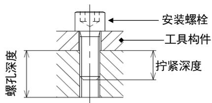
请根据工具构件的厚度选择安装螺栓的长度，使其达到规定的拧紧深度。
