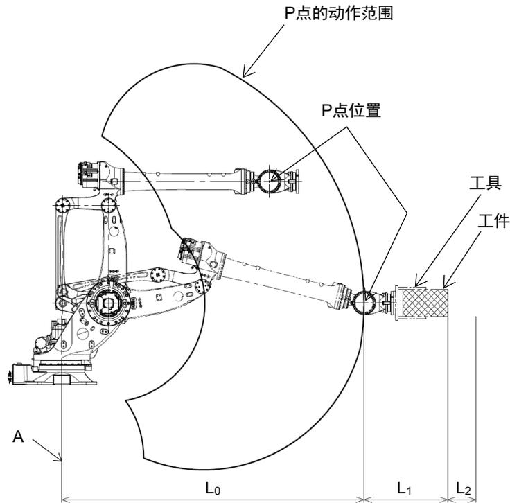
后面说明的机器人的动作范围在图中以P点的动作范围表示。因此，安全栅栏是从手臂的中心线（图中的A）开始加上 $L_0$ 的尺寸+到手腕的法兰的尺寸和工具的最大尺寸的和： $L_1$ 再加上预留的尺寸： $L_2$ ，如图所示，请确保 $L_0+L_1+L_2$ 的尺寸。关于 $L_0$ 的尺寸，请参阅“3.2 动作范围和规格”。
