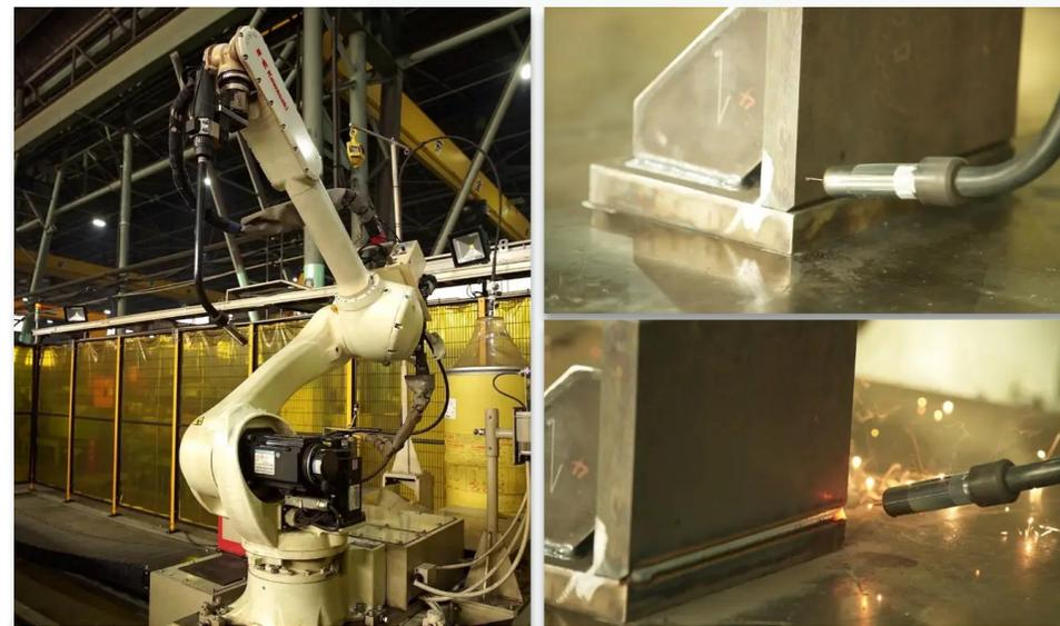
在为一座大型立交桥制作建筑材料的过程中引入自动焊接工艺
