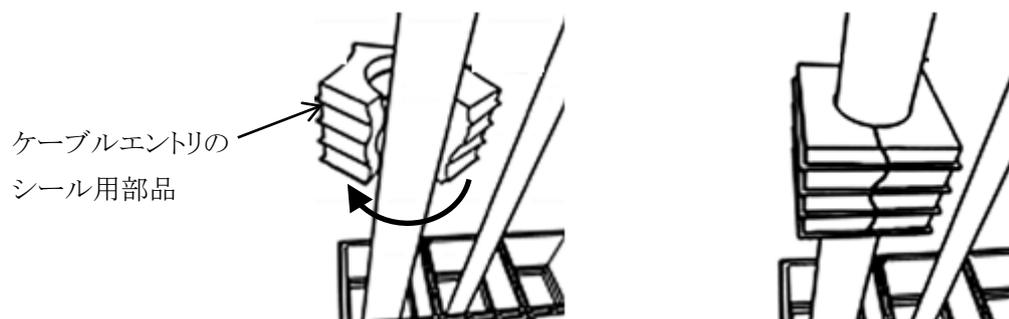
8. ケーブルエントリのシール用部品を格子状部品に最後まで押し込みます。
