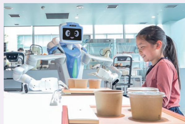
実証実験用に一般公開されるレストランで配膳するアーム付き自走式ロボット「Nyokkey」
