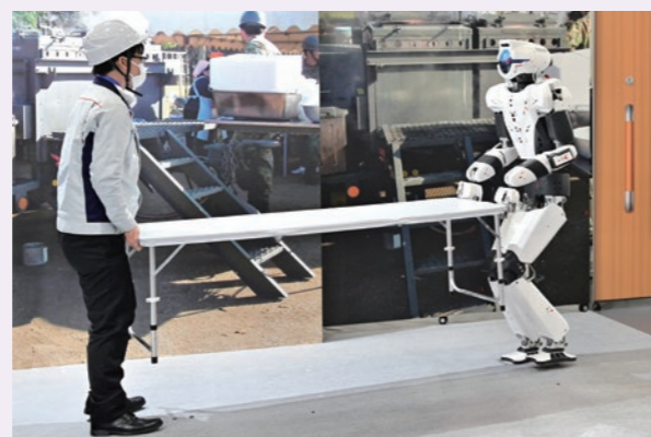
人間と協働し重量物を選び移動するヒューマノイドロボット「Kaleido」
