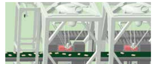
コンベアと同期し、移動する対象物の現在位置を検出
