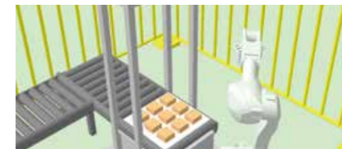
固定カメラやハンドカメラによる対象物の把持位置補正
