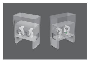
K-Lab2 はクリーンベンチ内で 2 台のロボットが稼働します。川崎重工は PoC 確立のための研究開発支援をしております。6 軸ロボット ×2 台の連携作業で付帯設備を削減することができ、ハンドツールおよび作業台の構成を変更することで別用途のリユースが可能になります。
