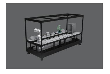
K-Lab1 では、必要なモジュールを設定したシステム構築が可能です。また、先々のモジュール追加およびレイアウト変更も柔軟に対応できます。これによりクリーン環境対応のロボットおよび走行レールなど川崎重工の幅広い製品を使用頂くことで、細胞培養や分析工程の自動化が可能になります。
