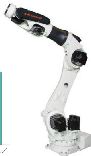
ロボットアームはリーチ2600mmクラスで最軽量であり、設置架台とその周辺の造作物減量に寄与します。また、必要なケーブル/ホース類を内蔵する中空構造であり、性能・品質を高めると同時に、スポット溶接用途での使いやすさを追求しました。
