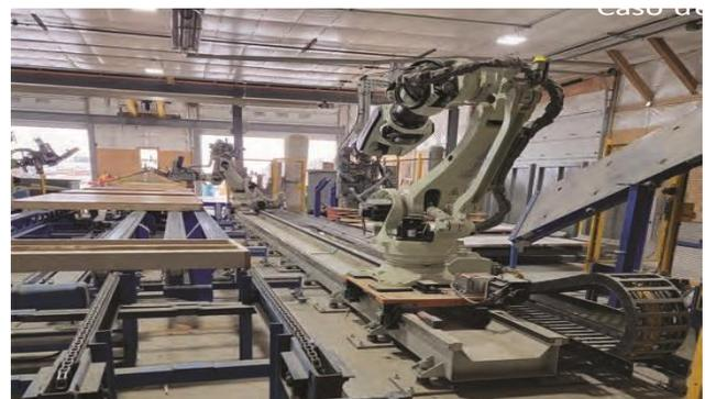
O robô Kawasaki BX250L pode levantar 250 kg em qualquer postura e oferece um design de cabos através do braço para maior conveniência.
